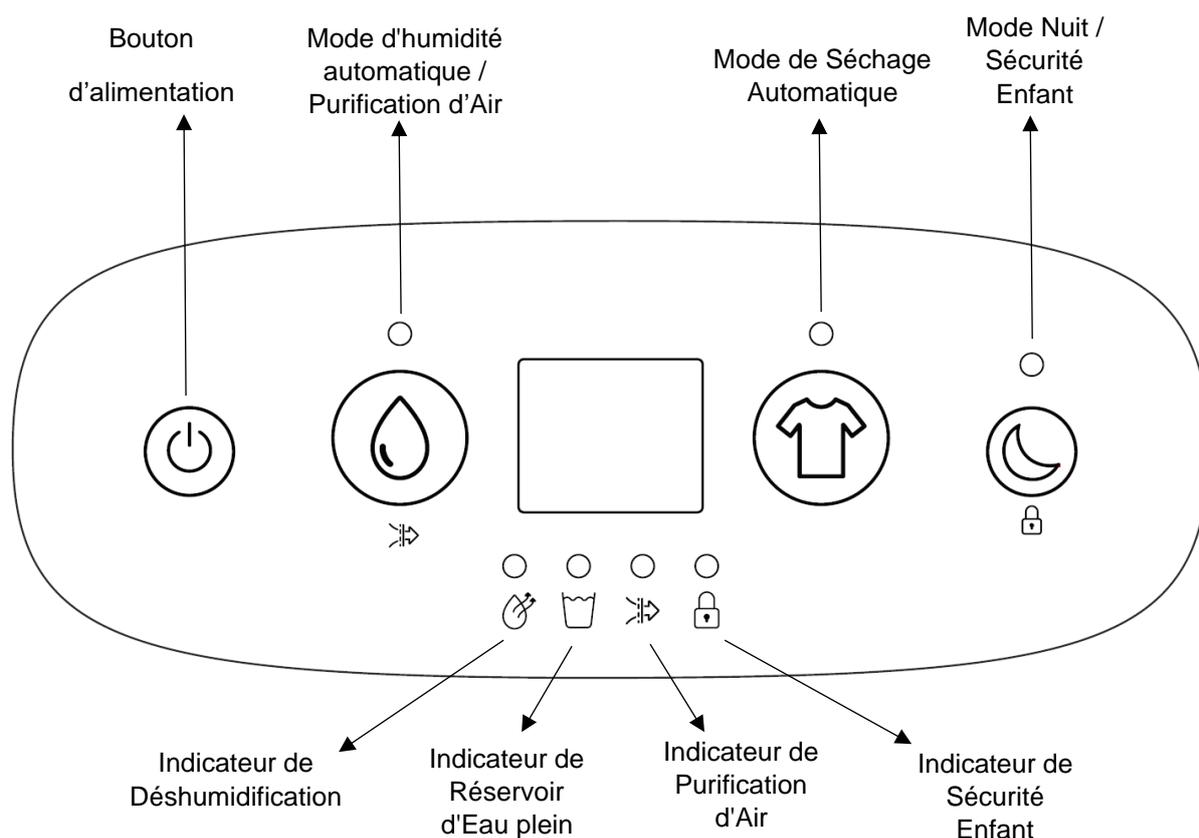
Lorsque le déshumidificateur est branché pour la première fois sur le secteur, il émettra un bip sonore, aucune lumière n'apparaîtra sur le panneau de commande. Tous les boutons du panneau de commande ne nécessitent qu'une légère pression. Appuyez fermement et rapidement sur les boutons.
