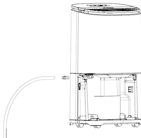
**Étape 2:** Retirez l'adaptateur à angle droit du couvercle du réservoir d'eau et pressez-le sur le bec verseur. Le bec verseur permet à l'eau de s'écouler hors du déshumidificateur et est situé sur le côté gauche.
