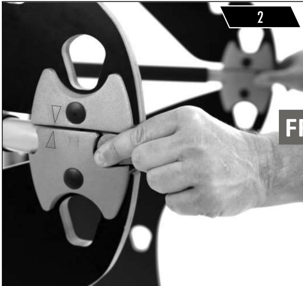
Appuyez sur les 2 boutons de déverrouillage de l'appareil simultanément
