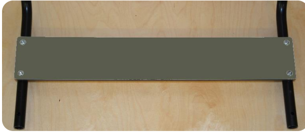
Figure 3 – Mise en place de la latte de compact sur les tubes bas
