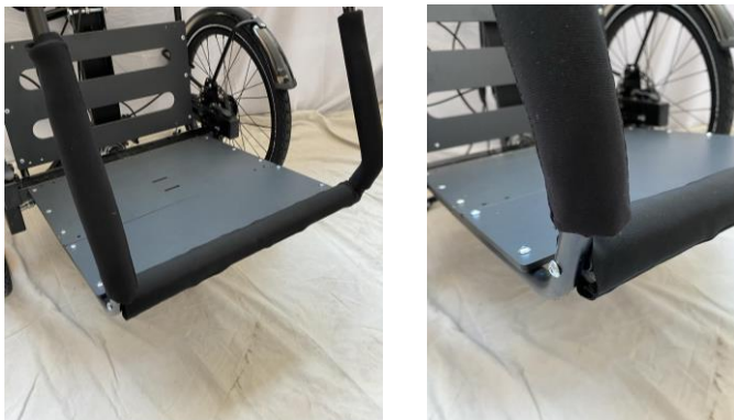
Figure 8 - Mise en place de la barre transverse du bas
