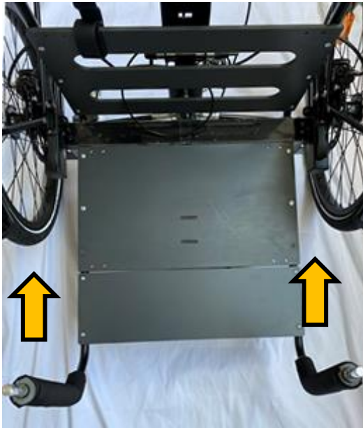
Figure 6 - Insertion des tubes avant dans l'assise
