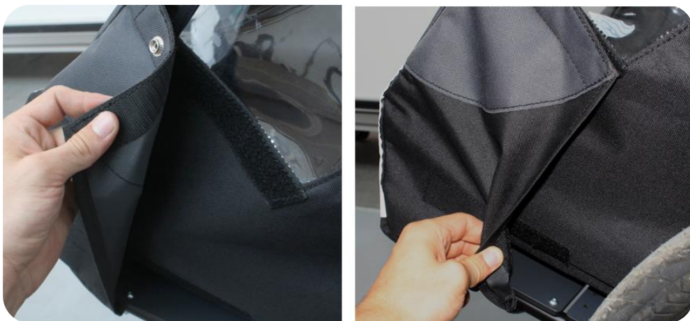
Figure 17a - Assemblage du textile inférieur sur le module
