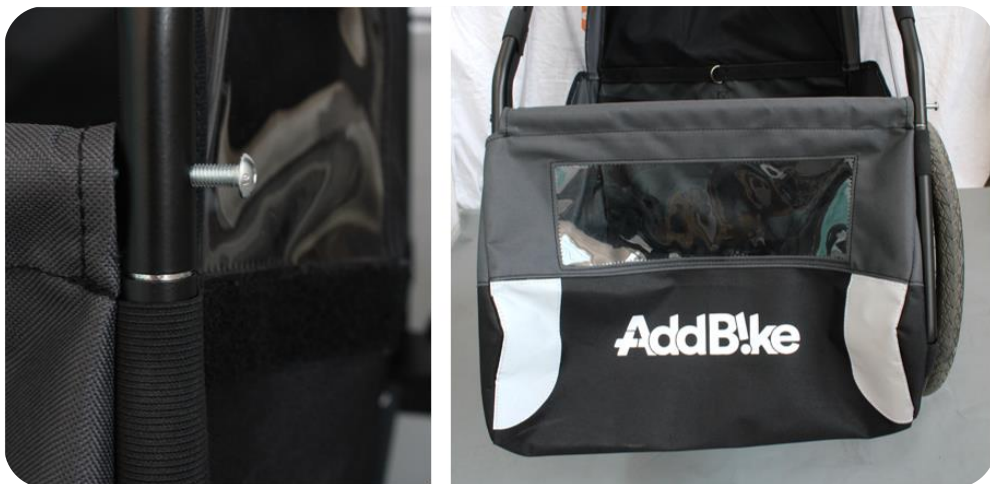
Figure 16 - Montage de la barre transverse
