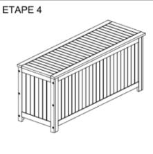
NB : Attention ne pas inverser les parois latérales droite et gauche du coffre ne pas trop serrer les charnières du dessus du coffre pour que celui-ci se referme correctement
