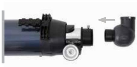
**NOTE :** Une diagonale en étoile ne permet pas d'obtenir la mise au point avec un télescope newtonien. L'image apparaîtra toujours inversée verticalement. Les télescopes newtoniens sont livrés avec un oculaire coudé de 20 mm spécial qui comporte un prisme de renvoi pour l'observation terrestre.
