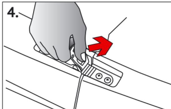
4. Serrez la boucle. Ne forcez pas sur la boucle, cela peut endommager la sangle à cliquet.
