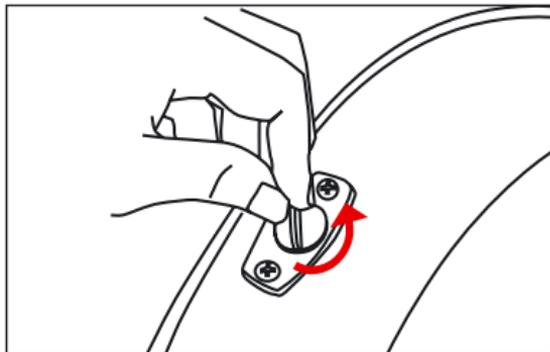
Égalisez toujours la pression dans le kayak en ouvrant les bouchons de vidange de chaque section avant l'assemblage.
