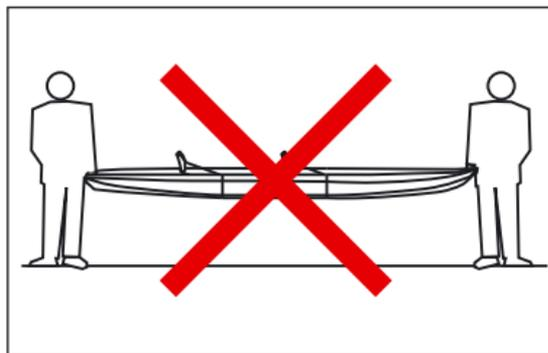
Ne jamais porter ou traîner le kayak lorsqu'il est assemblé en tandem, cela peut endommager le système de verrouillage. Transportez le kayak pièce par pièce.
