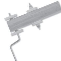
02 - Installez la poulie, l'axe en fer, la manivelle et les éléments de fixation comme indiqué ci-dessous.
