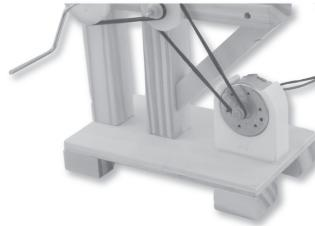
06 - Corte a fita adesiva dupla no mesmo tamanho da parte inferior da base do motor e cole-a na placa inferior. Em seguida, instale o motor na base do motor.
