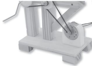
06 - Coupez une section de ruban double face de la même taille que la base du support du moteur et collez le support sur la plaque inférieure. Ensuite, installez le moteur dans son support.
