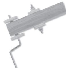
02 - Scheiben, Metallwelle, Handkurbel und Lager in der gezeigten Ausrichtung montieren.
