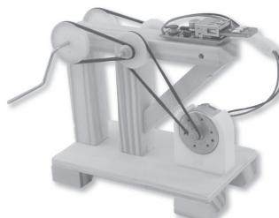
08 - Conecte a placa auxiliar e o motor aos fios.
