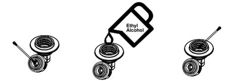
5. Nettoyage en profondeur : Il est recommandé de procéder à un nettoyage complet tous les 1 à 2 mois. Nettoyez le disque de brumisation du module de brumisation avec un coton-tige imbibé d'alcool (concentration d'alcool  $\geq 75\%$ ) ou d'eau chaude et nettoyez l'intérieur du module de brumisation avec de l'alcool (remplissez l'intérieur du module de brumisation avec de l'alcool, videz l'alcool après 1 à 2 minutes et laissez sécher).
