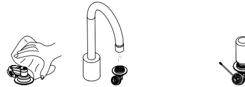
1. Lors d'un changement d'huiles essentielles, il est recommandé d'essuyer le module de brumisation avec un chiffon en coton propre ou de rincer l'intérieur du module de brumisation à l'eau.
