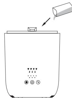
**3.** Encher o reservatório de água, sem ultrapassar a linha que indica o nível máximo (2 l). Nunca colocar água na saída de ar, uma vez que isto pode provocar avarias no aparelho.
