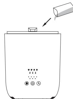
**3.** Den Wassertank füllen, ohne die Linie für den maximalen Wasserstand (2 l) zu überschreiten. Darauf achten, dass niemals Wasser in den Luftauslass gelangt, dies könnte zu einer Fehlfunktion des Geräts führen.
