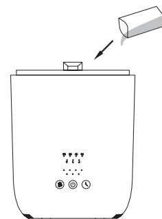
**3.** Remplir le réservoir d'eau sans dépasser la ligne indiquant le niveau d'eau maximum (2L). Ne jamais mettre de l'eau dans la sortie d'air, ceci pourrait causer un dysfonctionnement de l'appareil.
