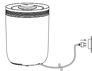
**6.** Den Adapter an eine Netzsteckdose anschließen.
